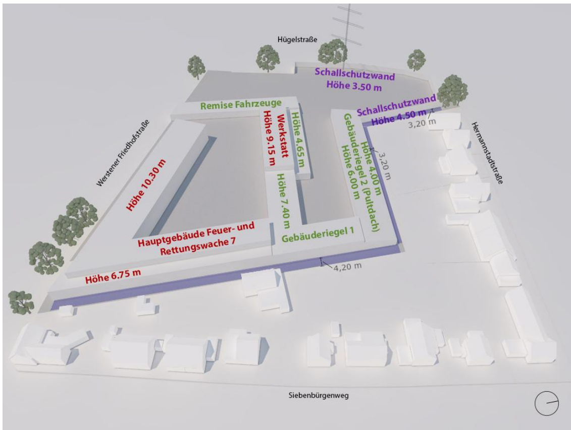
Abbildung 1 Schematische Darstellung der einzelnen Gebäuderiegel: Feuerwehr (Rot) und Gartenamt (Grün), mit Gebäudehöhen und Grenzabständen.
