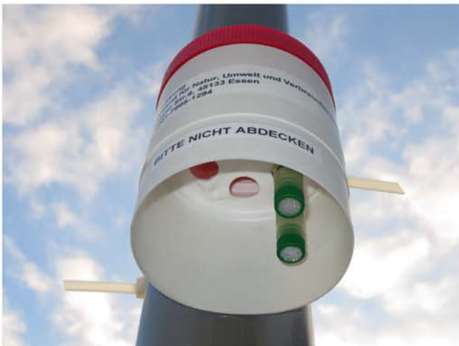
Passivsammler für NO 2 im Schutzgehäuse
