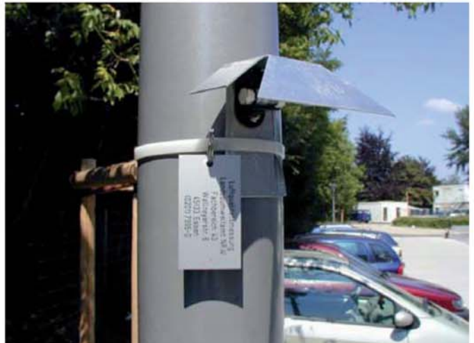
Passivsammler für Benzol im Schutzgehäuse
