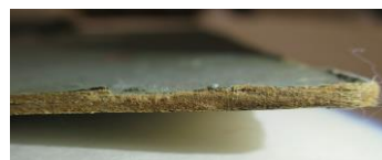
Délitement du carton de support après découpe de la tranche. Décollage du papier bleu au revers
