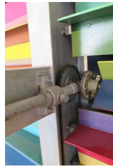
Détail du mécanisme de l'oeuvre, à base de plateaux et de chaînes de vélo
