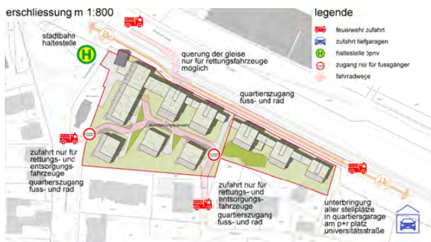
Erschließung (M1:800- verkleinert)
