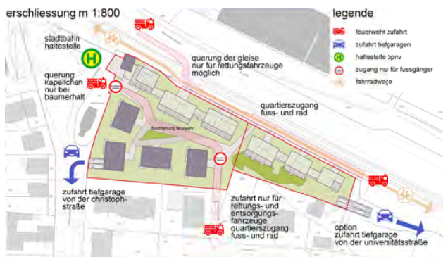
Erschließung (M1:800- verkleinert)
