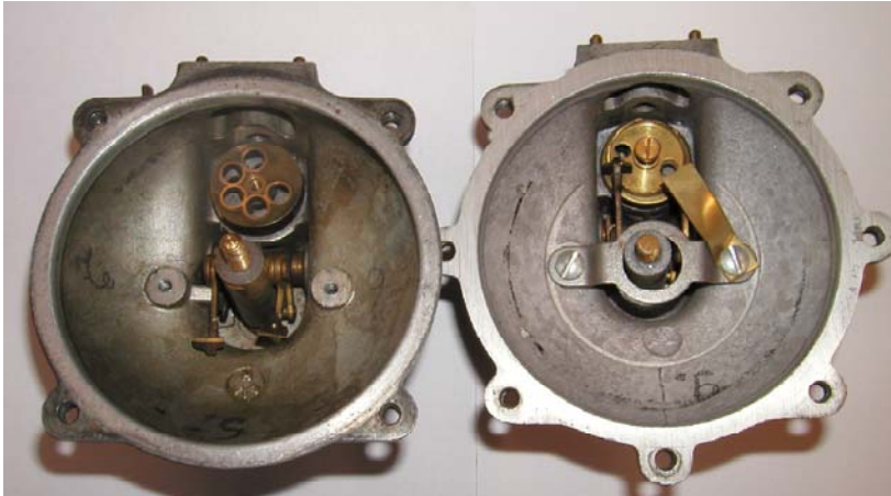
Bild 12: Stellung des Drehschiebers nach der 1. Druckwelle
