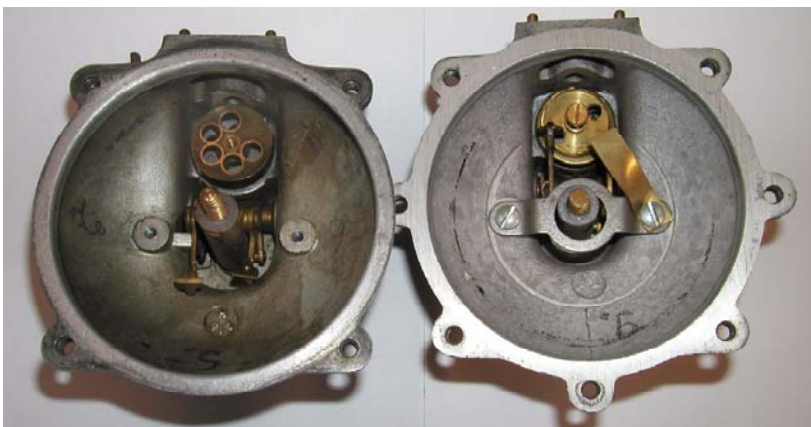
Bild 13: Stellung des Drehschiebers nach der 2. Druckwelle
